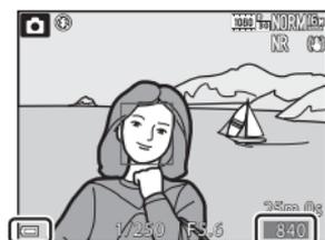
Indicateur du niveau de charge de l'accumulateur
